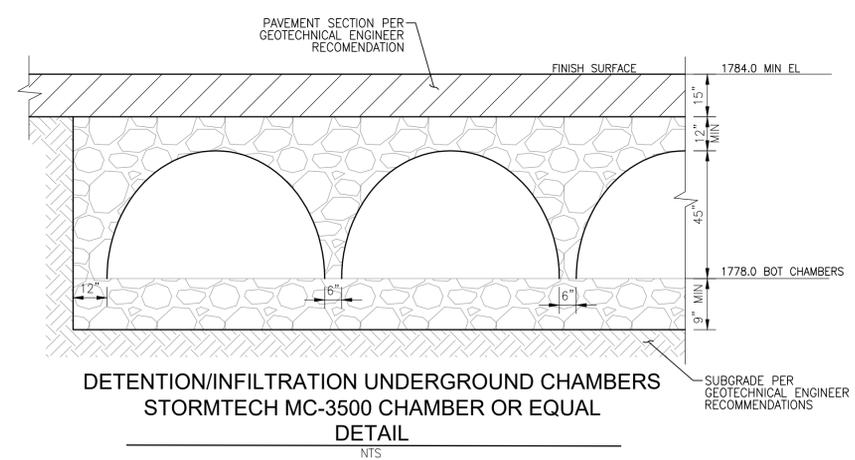
DETENTION/INFILTRATION UNDERGROUND CHAMBERS
