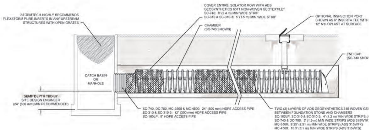
\* NOTE: NON-WOVEN FABRIC IS ONLY REQUIRED OVER THE INLET PIPE CONNECTION INTO THE END CAP FOR SC-160LP, DC-780, MC-3500 & MC-4500 CHAMBER MODELS AND IS NOT REQUIRED OVER THE ENTIRE ISOLATOR ROW.
