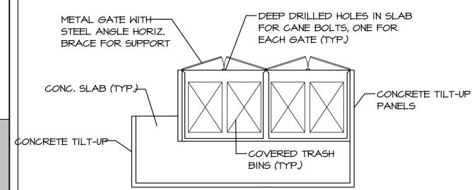
TRASH ENCLOSURE PLAN DETAIL
