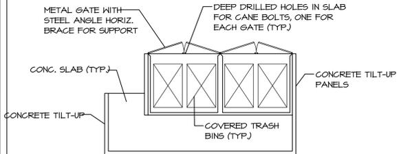
**TRASH ENCLOSURE PLAN DETAIL**
