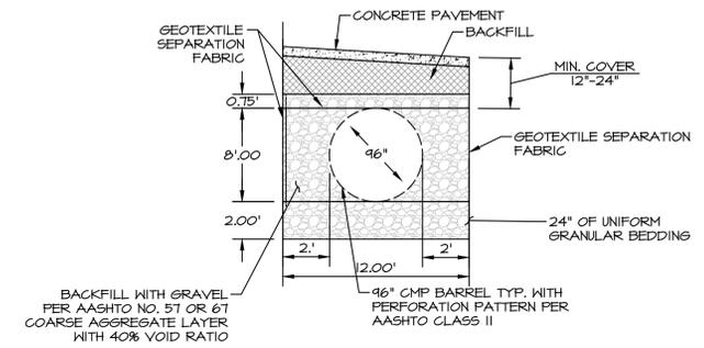
**CMP DETENTION SYSTEM TYPICAL DETAIL**
