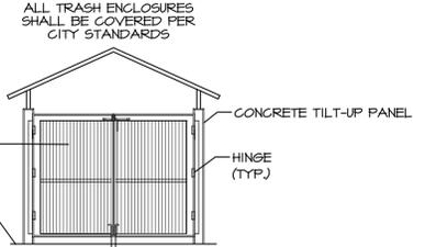
**TRASH ENCLOSURE GATE ELEVATION**
