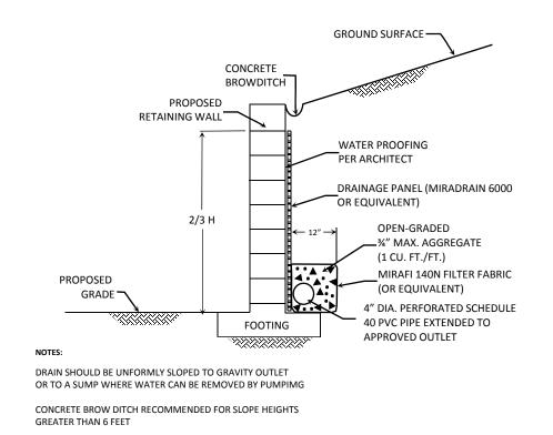
TYPICAL RETAINING WALL DRAIN DETAIL
