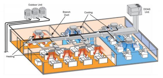
Figure 2 VRF Schematic
